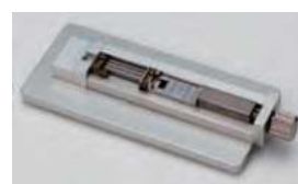
引張りプローブ用試料取付治具
