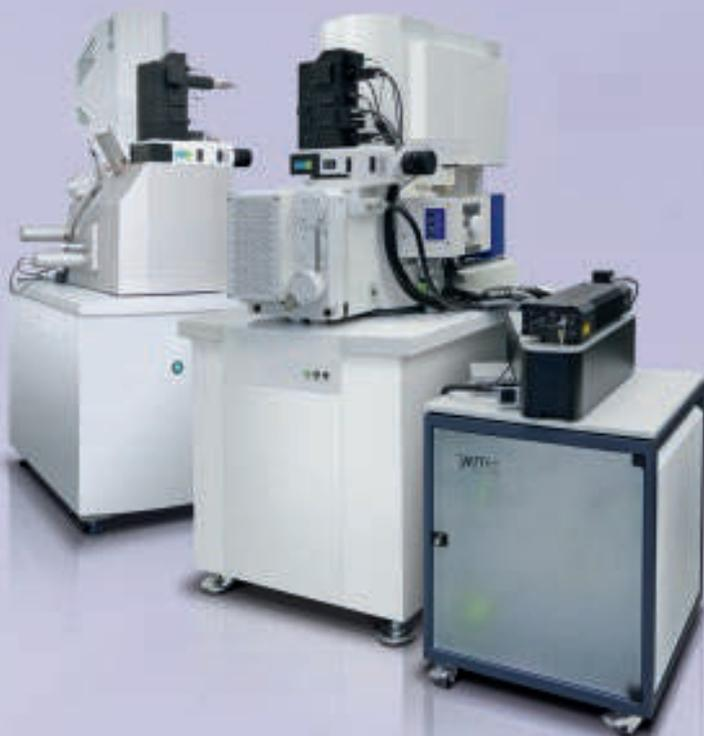
RISE™顕微鏡は、SEMと共焦点ラマンイメージングを組み合わせた、新しい相関顕微鏡法です。RISE™顕微鏡は、超微細構造の表面特性と化学組成の情報をリンクさせることができます。alpha300 R共焦点ラマンイメージング顕微鏡とSEMの全機能を併せ持つ装置となっています。
