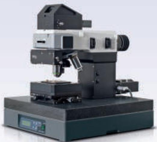
WITec alpha300 A原子間力顕微鏡は、ナノスケールの表面特性評価を実現します。研究用グレードの光学顕微鏡を内蔵しており、カンチレバーの位置合わせや、高分解能でサンプルの観察場所の特定が簡単にできます。
