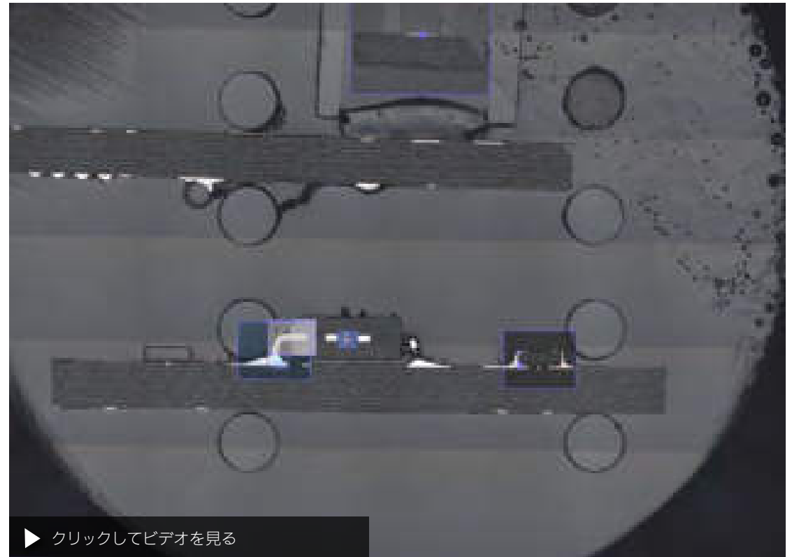
光学顕微鏡、SEM、EDS マップの画像を一つの画像上で相関した画像。試料：電子部品断面。ご提供：Aalen University, Materials Research Institute, Aalen, Germany
