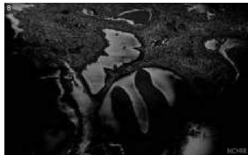
マウス肺組織のブロックフェイス画像。Focal Charge Compensation あり (A)、および Focal Charge Compensation なし (B)。スケールバー：1μm。ご提供：NCMIR, University of San Diego, US
