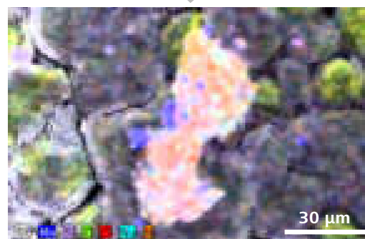
リチウムイオン電池。上：光学顕微鏡画像。中央：SEM 画像。 下：両方を EDS 分析と合わせて重ね合わせ。
