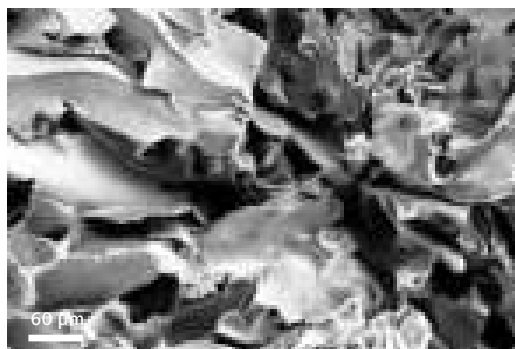
破断面－引張状態での鋼試料の脆性破壊。 ご提供：The Test House, Cambridge, United Kingdom
