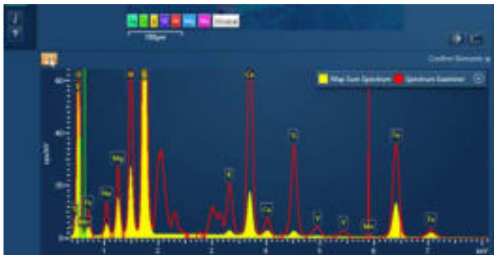
スペクトル全体では識別できない小さなピークを強調。この例ではリンを含むわずかな相を発見
